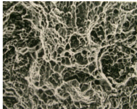
図7-4,最終破断部の走査電子顕微鏡写真
